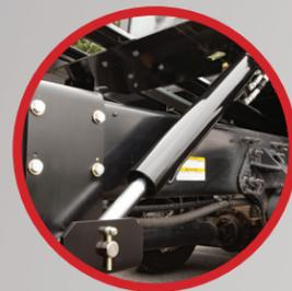
CILINDROS DE INCLINACIÓN EXTERIORES
